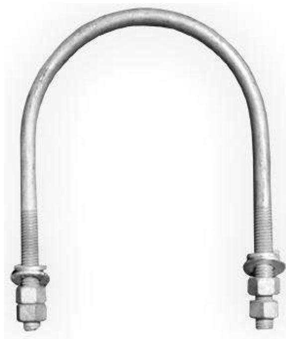
Abrazadera para cañerías, U BOLTS. Usadas para soportar cañerías ASTM A53 SCH 40, ASTM A106, etc. También para tuberías HDPE, barras redondas, etc. Se describen por el tamaño de la cañería las cuales se miden por su diámetro interior. El diámetro de la barra redonda con la cual se fabrica la abrazadera esta normada según ficha técnica, pero se pueden fabricar con el diámetro que el cliente solicite. Pueden incluir tuercas y o golillas planas.
