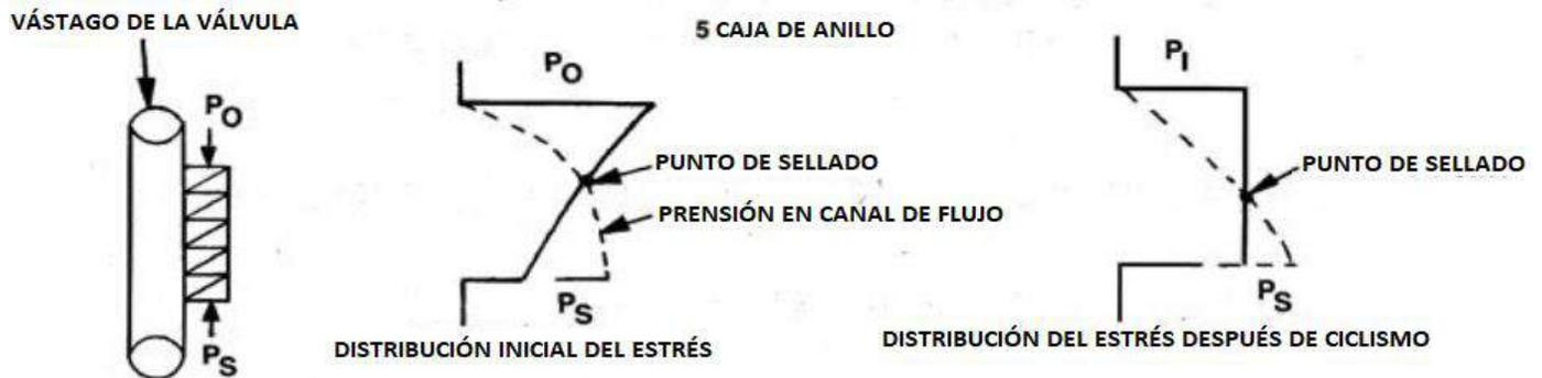
Cuando la tensión del punto de sellado iguala o excede la presión de la línea, se logra el sellado. Después del ciclo, las tensiones se distribuyen y se baja el punto de sellado. Una vez que el empaque se desgasta, el punto de sellado se baja más y, finalmente, no habrá ningún punto de sellado para evitar fugas.
